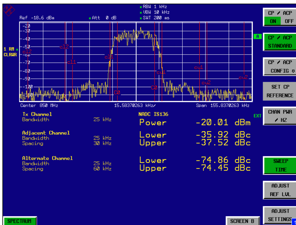
Fig. 2-1 Messung der relativen Nachbarkanalleistung eines NADC-Signals in je zwei Nachbarkanälen unterhalb und oberhalb des Sendekanals.
